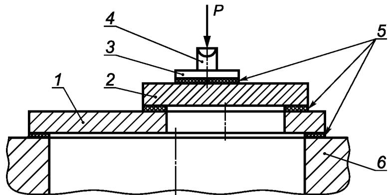
1 — плита перекрытия; 2 — стальная плита; 3 — нагрузочная плита 300×300 мм;
