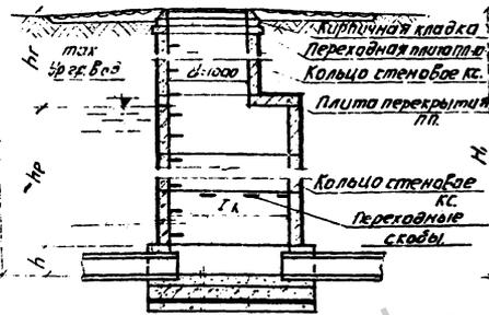
Бетон М-200 с затиркой поверхности лотка
