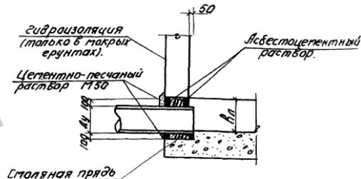
Заделка труб в макропористых просадочных грунтах
